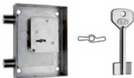
Cerradura de arrastre, 2 llaves de gorja de latón niquelado AGA-9G de 72 mm, 49 de caña y paletón de 13,5 mm, recorrido de palanca 21 mm, con dos bulones de acero.
