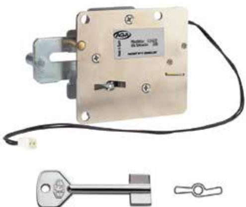
Cerradura de arrastre sencillo con mecanismo de emergencia (cada cerradura dispone de su propia llave de emergencia), 2 llaves de gorja de latón niquelado AGA-11G de 72 mm, 49 de caña y paletón de 15,7 mm, recorrido de palanca 21 mm.
