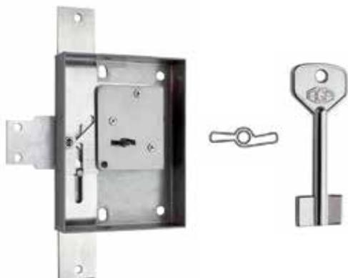
Cerradura de arrastre, 2 llaves de gorja de latón niquelado AGA-9G de 72 mm, 49 de caña y paletón de 13,5 mm, recorrido de palanca 21 mm y 3 puntos de bloqueo.
